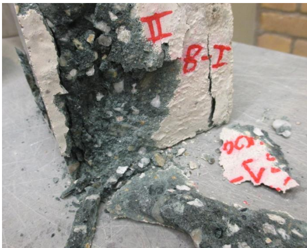
Foto 3 Proefstuk van geopolymeerbeton uit het afstudeeronderzoek van Silke Prinsse [3]
